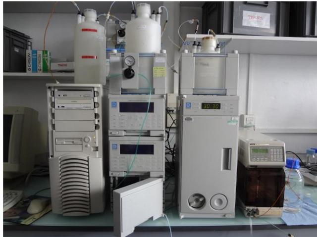
**Matériel :** chromatographe DX500 à détection ampérométrique pulsée (DIONEX).
