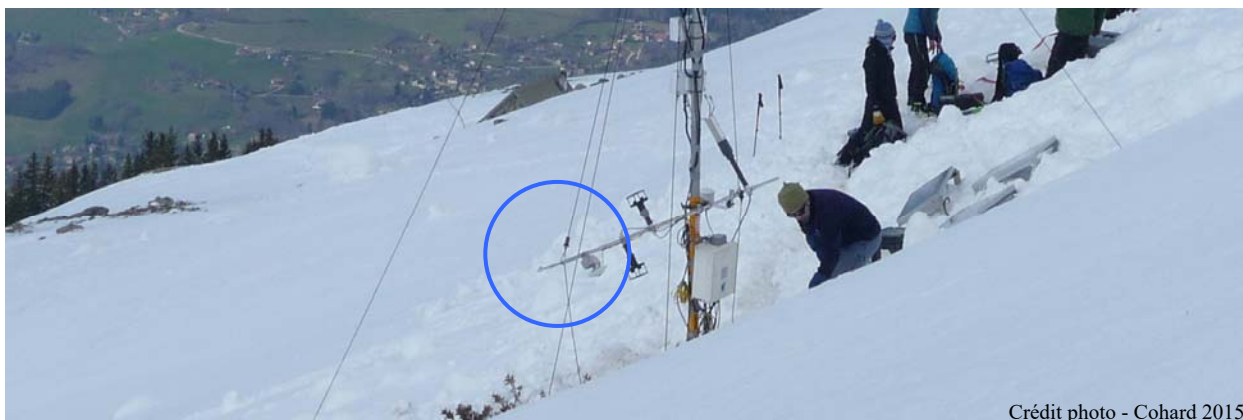
Fig. II-4: mesure micro-météorologique sur les pentes du Grand Colon (Isère). Les capteurs de rayonnement (CNR2 – Kipp&Zonen et CGR4 – Kipp&Zonen) sont placés parallèlement à la pente 31°.
