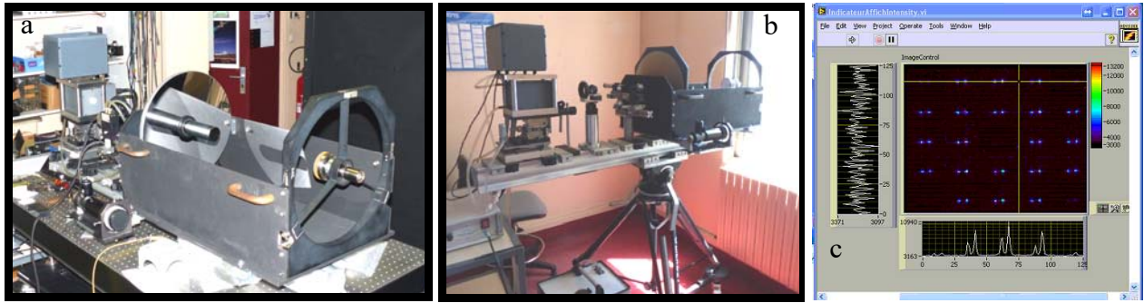
Figure VI-5: a-b) prototype du SCINDAR après la restructuration de l'Analyseur de Surface d'Onde disponible à l'ONERA. c) matrice d'images de deux sources observées par le SCINDAR.
